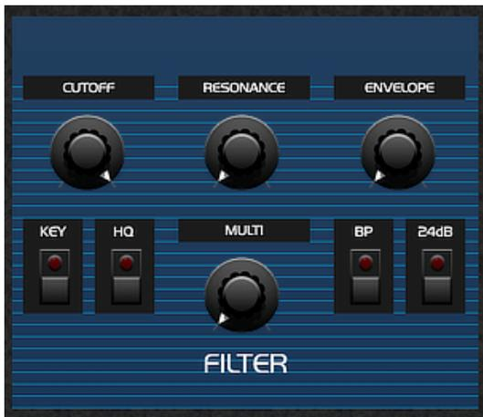
これには、Oberheim SEM module ( オーバーハイム SEM モジュール ) のような Multimode 12dB/octave filter ( マルチモード 12 デシベル/オクターブフィルター ) が実施されています。**MULTI** のロータリーコントロールを使用するには、完全にローパスを左にクロスフェードし、デフォルトによるノッチ又は BP スイッチを使用したバンドパスを 12 時の方向に、そしてハイパス ( 高域 ) を一番左にします。
