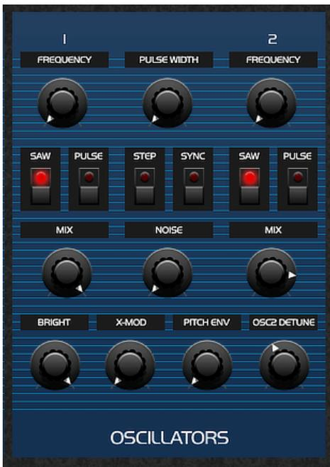
ミキサーはオリジナルデザインの固定レベルよりも、より柔軟性のある二つのオシレーターとノイズ源をブレンドするために導入されました。OB-Xクロスモデュレーション(周波数変調)の中では、OSC2からOSC1に変調しました。OB-Xdでは、これとは逆にOSC1からOSC2に変調します。シンセとx-modによって作り出されたサウンドは、基の変調経路の不協和音効果よりも有効的と判断されました。
